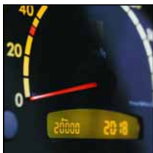
El sistema ASSYST le indica cuándo deben realizarse los servicios de mantenimiento requeridos.
