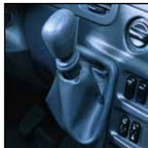
Palanca de cambio tipo joystick integrada al tablero de instrumentos.
